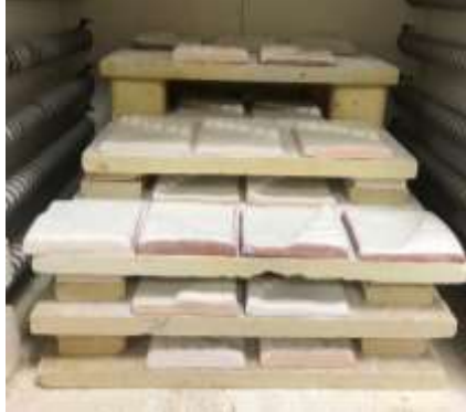
Resim 6: Sırlanan plakaların fırına yerleştirilmesi (Beyza Nur KUM arşiv, 2022).
