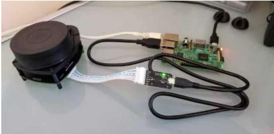
Şekil 5. Lidar sensörünün USB-TTL seri dönüştürücü
