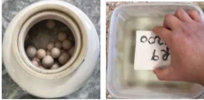
Resim 5: Hammaddeleri öğütmek için kullanılan değirmen ve Hazırlanan sırlın daldırma yöntemi ile plakalara uygulanması (Beyza Nur KUM arşiv, 2022).
