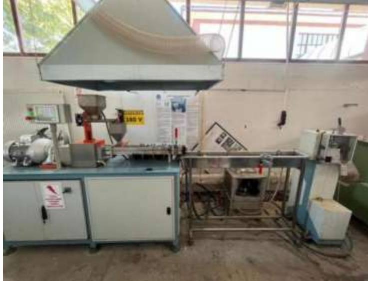
Şekil 5. Plastik Ekstrüzyon Makinesi/Kütahya Dumlupınar Üniversitesi, Mühendislik Fakültesi, Makine Mühendisliği Bölümü Laboratuvarı
