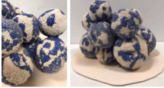
Resim 11: Beyaz bünyenin sır pişirimi sonrası görüntüsü. (R-9 %3 kobalt oksit, 1000°C), (Beyza Nur KUM arşiv, 2022)
