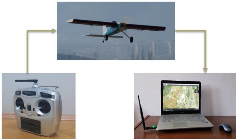
Şekil 3 İHA'nın Uçuş verilerinin YKİ'ye Aktarılmasının gösterimi
